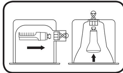
3 Vérifiez l'état de la douille de lampe dans le luminaire. Si elle est endommagée ou corrodée, remplacez-la par une nouvelle. Insérez les lampes à DEL à 4 broches de Current. Pour l'application horizontale, tournez la lampe de sorte que le diffuseur soit tourné vers l'ouverture luminaire.
